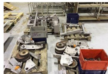
**Semaine 50** : intervention par Mécamont Hydro à Lannemezan pour le démantèlement de la cabine : démontage mécanique de toutes les pièces, sablage et préparation aux contrôles dimensionnels.
