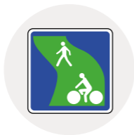
C - Voie réservée, piétons et cyclistes
