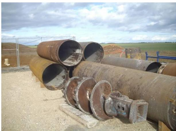
La tarière et les coffrages utilisés pour la réalisation des piliers
